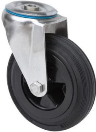
Räder aus natürlichem grauem Gummi, alle Bestandteile sind aus rostfreiem Stahl (AISI 304). Geeignet für Ladungen bis zu 215 kg.
