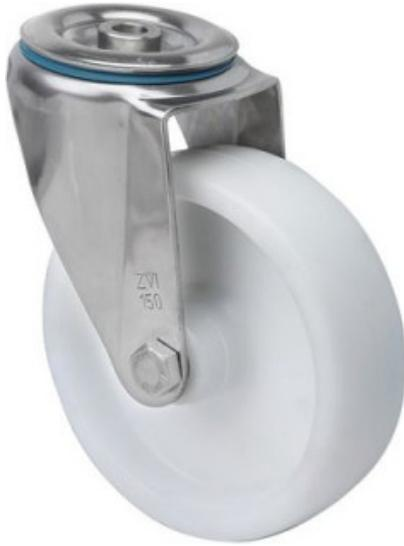
Räder aus weissem Polypropylen, alle Bestandteile sind aus rostfreiem Stahl (AISI 304). Geeignet für Ladungen bis zu 400 kg.
