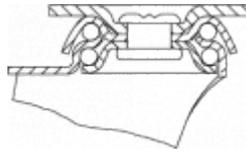
Hergestellt aus tiefgezogenem Stahlblech gepresst bis 2 mm. Verzinkt Lenkrollen-Gehäuse mit zweifacher Kugellagerung im Drehkranz. Hergestellt gemäß Europanorm EN 12530.
