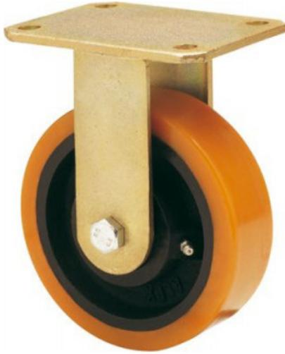
Räder mit Stahlkern und Reifen aus geschmolzenem Polyurethan mit einer Härte von 95° shore A. Geeignet für Ladungen bis zu 600 kg.
