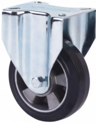
Räder mit Stahlkern und Reifen aus elastischem schwarzem Gummi mit einer Härte von 70° shore A. Geeignet für Ladungen bis zu 450 kg.
