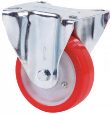
Räder mit weissem Nylonkern und Reifen aus rotem Polyurethan mit einer Härte von 90-95° shore A. Geeignet für Ladungen bis zu 600 kg.
