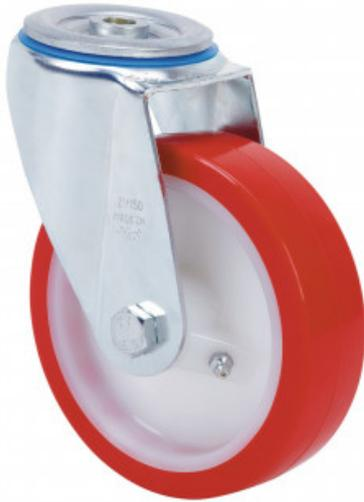
Räder aus weissem Nylonkern und Reifen aus rotem gespritztem Polyurethan mit einer Härte von 90-95° shore A. Geeignet für Ladungen bis zu 400 kg.
