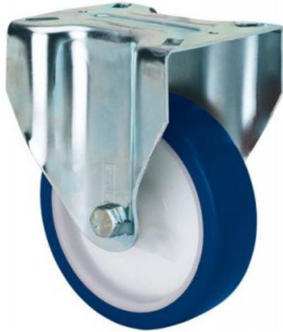
Räder mit weissem Polypropylenkern und Reifen aus gespritztem blauem Polyurethan mit einer Härte von 80° shore A. Geeignet für Ladungen bis zu 250 kg.
