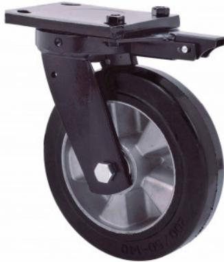
Rollen mit Aluminiumkern und Reifen aus elastischem schwarzen Gummi mit einer Härte von 70° shore A. Sie sind besonders für schwere Ladungen bis zu 500 kg geeignet.
