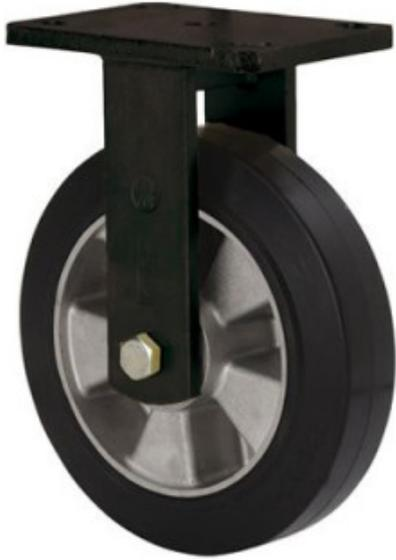
Rollen mit Aluminiumkern und Reifen aus elastischem schwarzen Gummi mit einer Härte von 70° shore A. Sie sind besonders für schwere Ladungen bis zu 500 kg geeignet.
