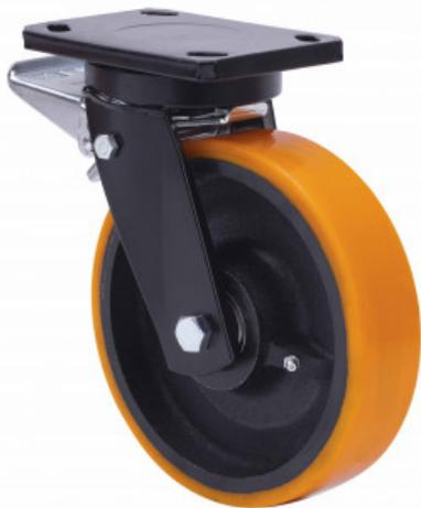
Rollen mit Stahlkern und Reifen aus geschmolzenem Polyurethan mit einer Härte von 95° shore A. Besonders geeignet für schwere Ladungen bis zu 1.900 kg.
